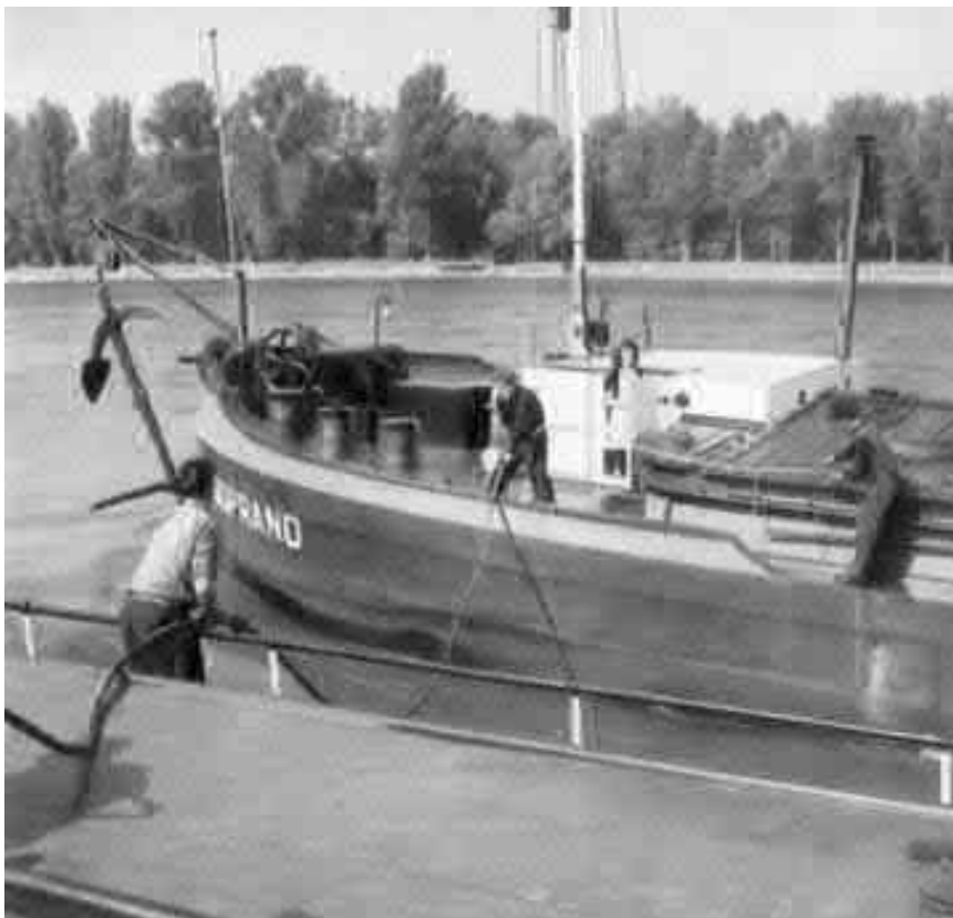
Der Schleppdraht wird zum Schleppschiff gezogen
