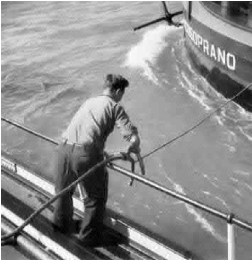
Dann der Schleppdraht an der Wurfleine festgemacht
