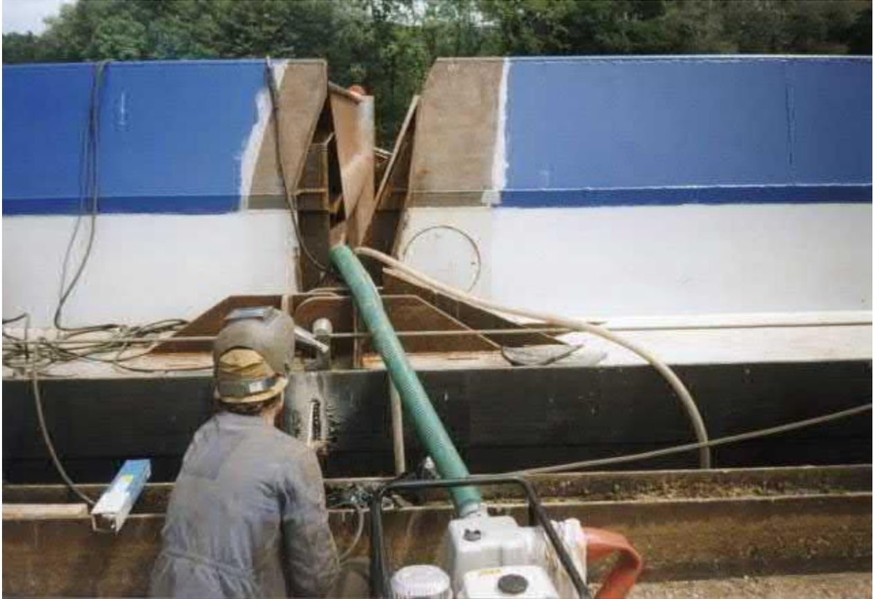
**Schweissarbeiten aussenbords. Vom Schiffsinnern muss dauernd Wasser abgepumpt werden.**
