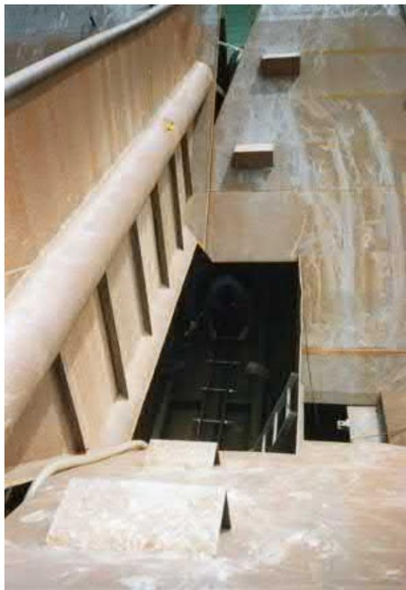
**Gegen Ende der Arbeiten, ein Laderaum mit einer Luke zum darunterliegenden Förderband ist jetzt gut sichtbar**
