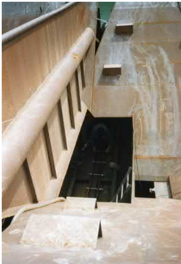
Verso la fine dei lavori, una stiva con un boccaporto che porta al sottostante nastro trasportatore é bene visibile. Photo: © Uwe Mayer / Marti AG
