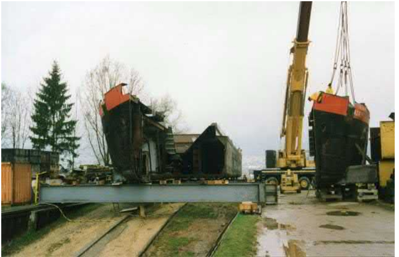
Cantiere di Arch. La parte prodiera viene assemblata Photo: © Uwe Mayer / Marti AG
