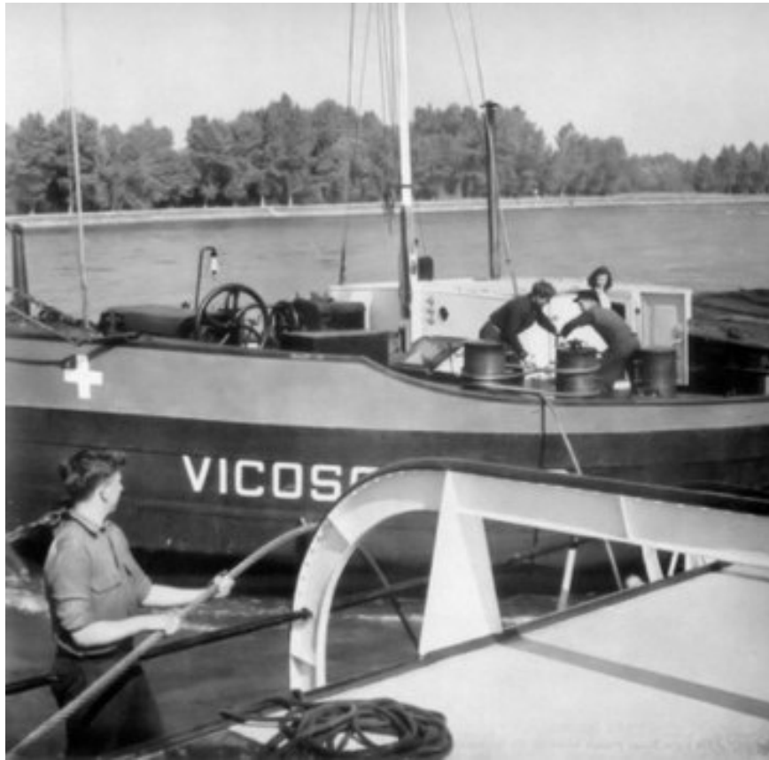
Der Schleppdraht wird auf den Pollern in 8-ter Schlägen belegt
