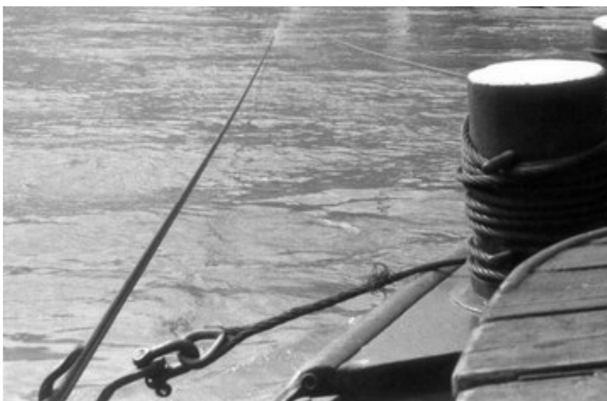
Brittelhaken mit 2 Strängen Photoherkunft: Archiv Harry de Groot
