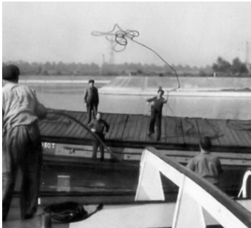
Die Wurfleine wird zum Schlepper hinübergeworfen
