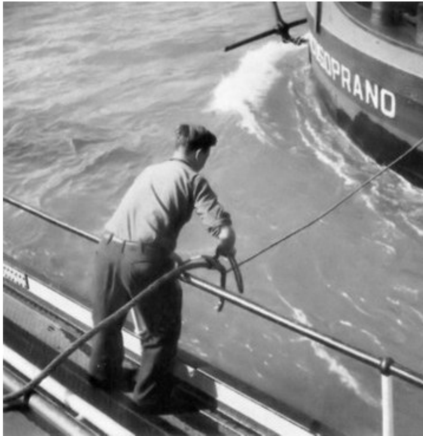
Dann der Schleppdraht an der Wurfleine festgemacht
