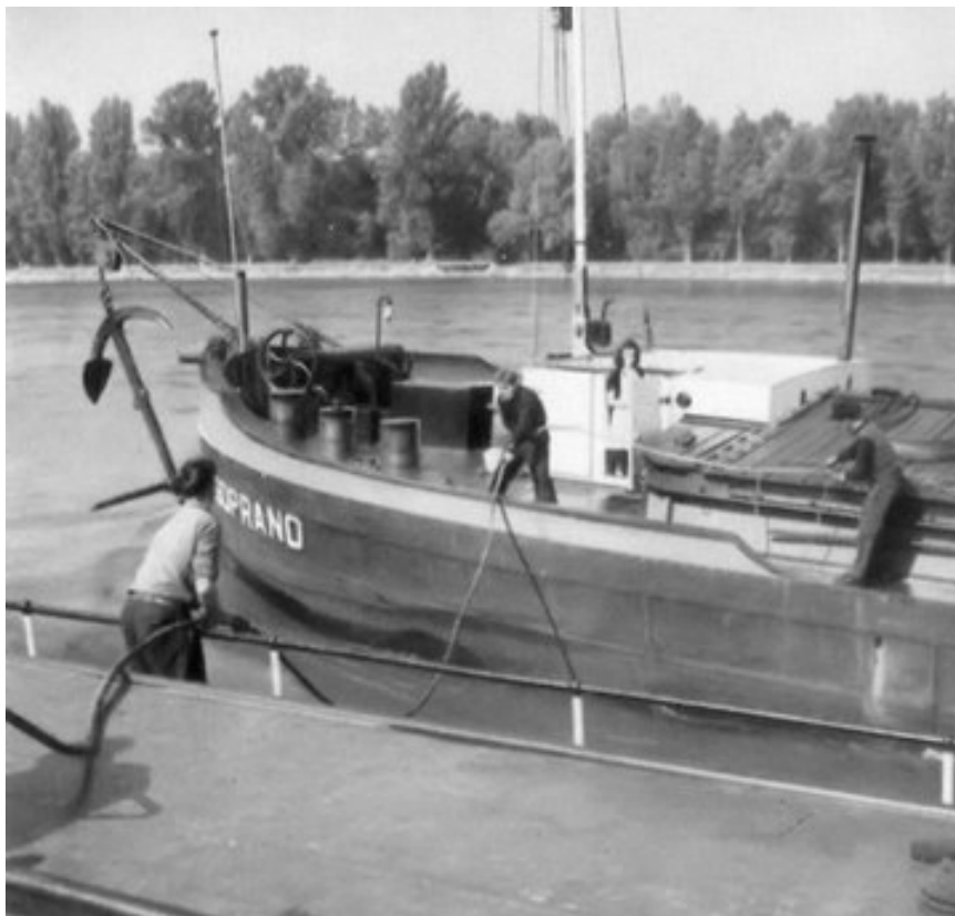
Der Schleppdraht wird zum Schlepsschiff gezogen
